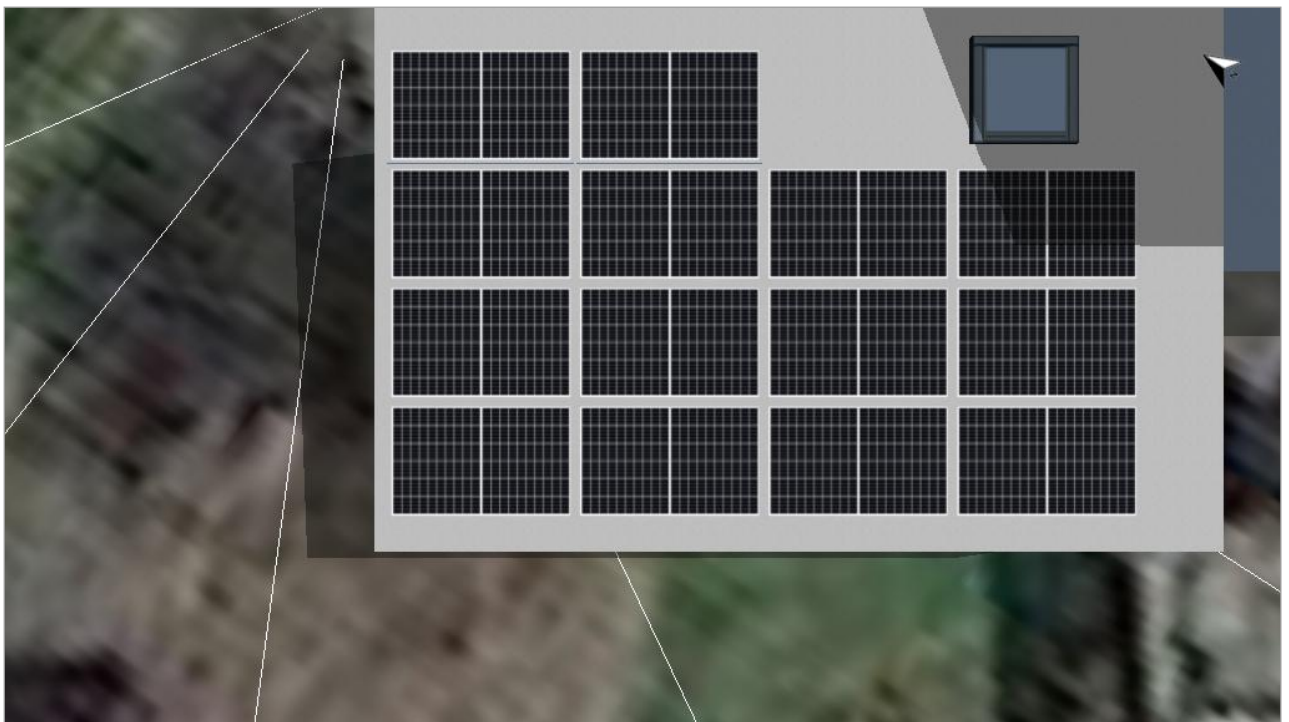
Abbildung: 1. Modulfläche - Gebäude 01-Dachfläche Südwest
